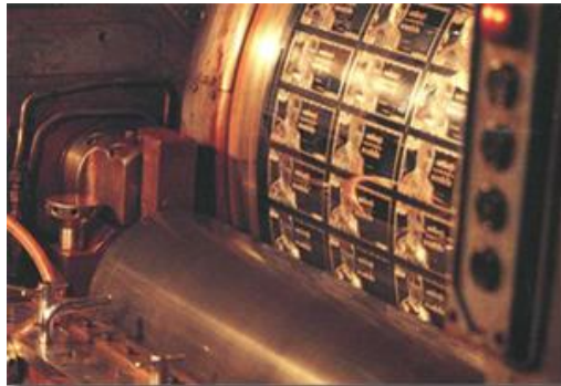
แม่พิมพ์ร่องลึกที่ใช้กับเครื่องพิมพ์ Intaglio
