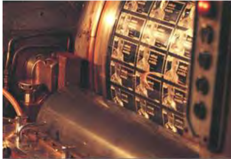
แม่พิมพ์ร่องลึกที่ใช้กับเครื่องพิมพ์ Intaglio
