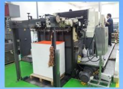
"MILLER" Offset printing machine 2 C กำลังการผลิตปกติ : 400,000 แผ่นพิมพ์/เดือน คิดเป็นไพ่ = 800,000 สำรับ/เดือน
