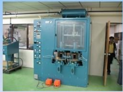
เครื่องตัดมุมและฉนิกทองมุมไฟ (Automatic Cornering & Gilding Machine) 4 เครื่อง กำลังการผลิตปกติรวม : 69,000 สำหรับ/เดือน
