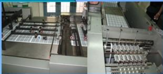
เครื่องตัดไฟป็อก (Automatic cutting machine round cornering No.1) กำลังการผลิตปกติ 140,000 สำหรับ/เดือน
